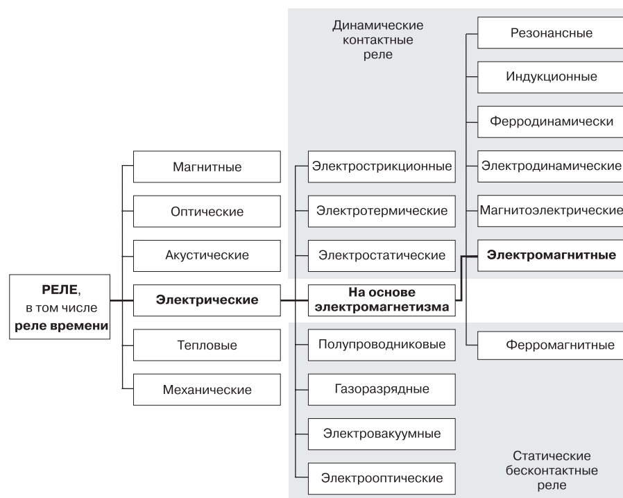
Рис. 1. Общая классификация реле, в том числе, классификация электрических реле и реле на основе электромагнетизма
