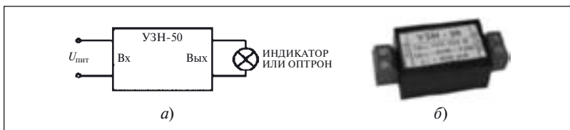
Рис. 24. Схема подключения (а) и внешний вид (б) устройства защиты от наводок 1
