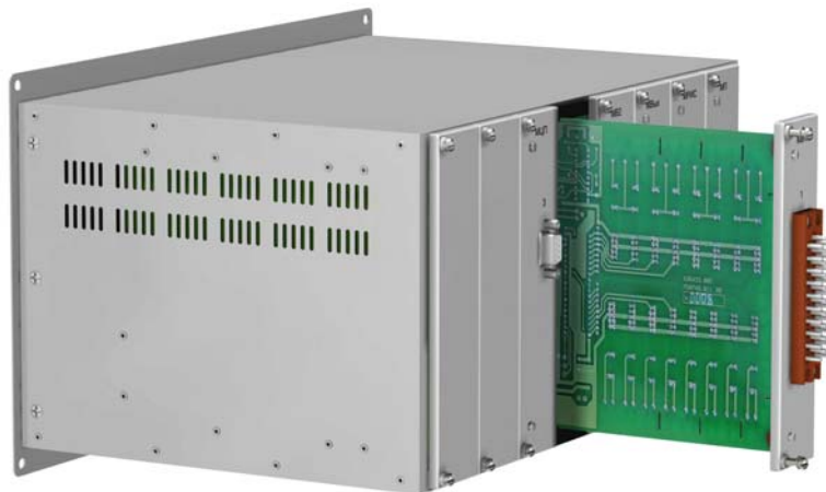
Рис. 53 Замена модуля в устройстве БМЦС
