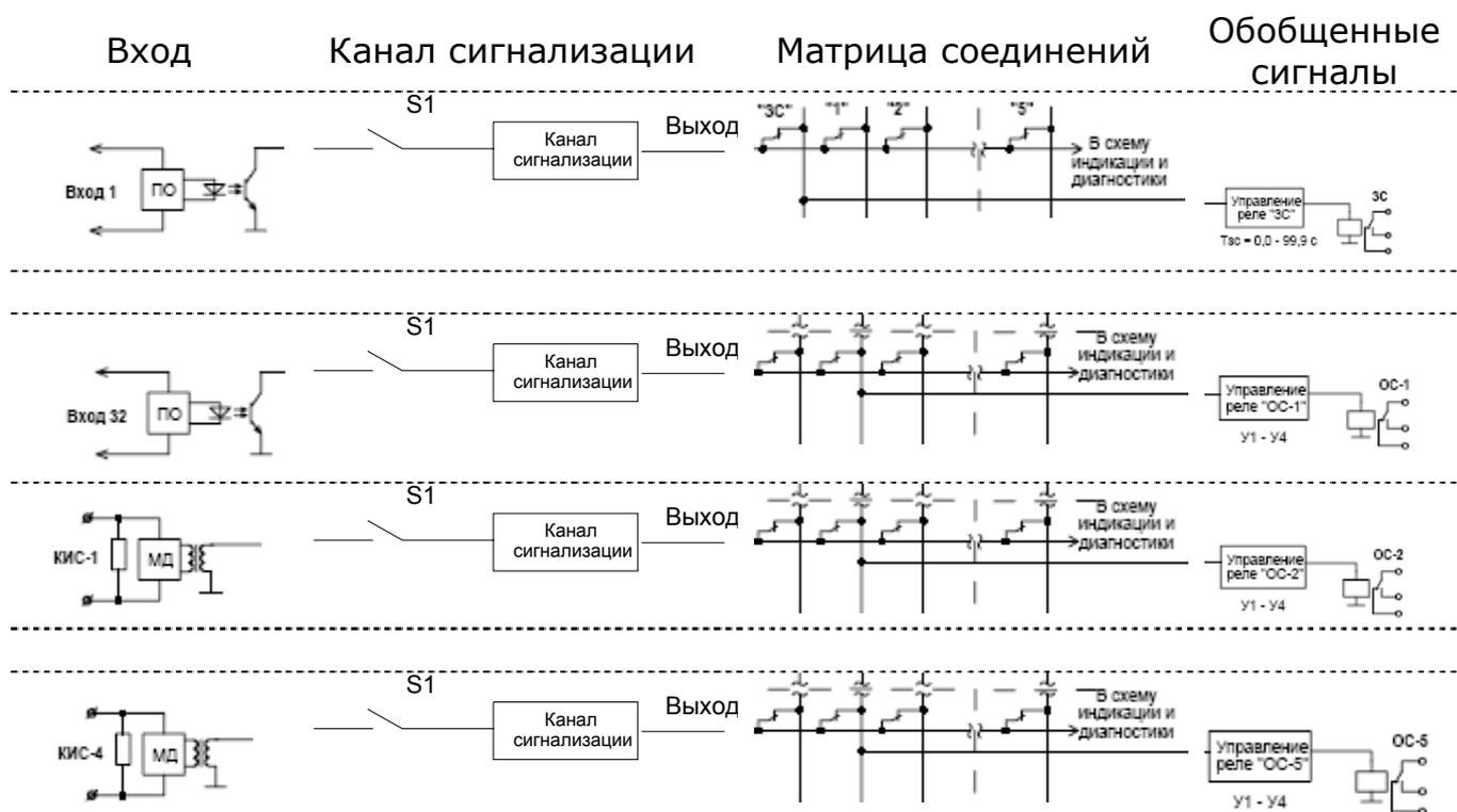
Рис. 6 Матрица соединений для получения обобщенных сигналов
