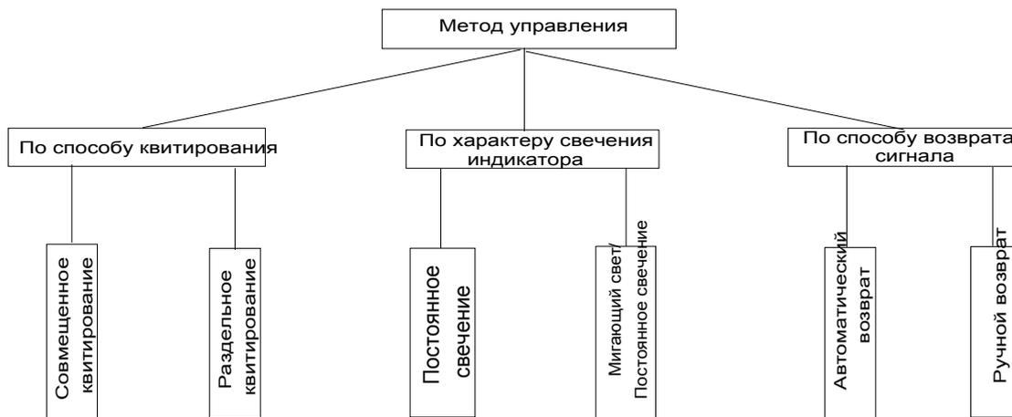
Рис. 11 Классификация методов управления обобщенными сигналами
