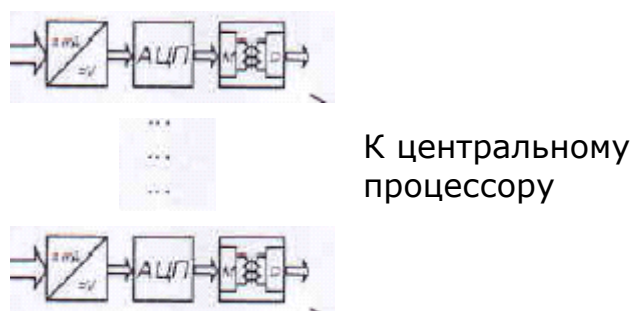
Рис. 5 Входы импульсной сигнализации устройства « Бреслер-0107.050 »
