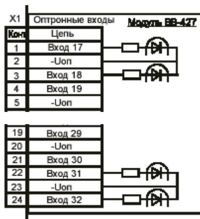
Рис. 7. Входы для дискретных сигналов в блоке **БМЦС** (а) и «Сириус-ЦС» (б)
