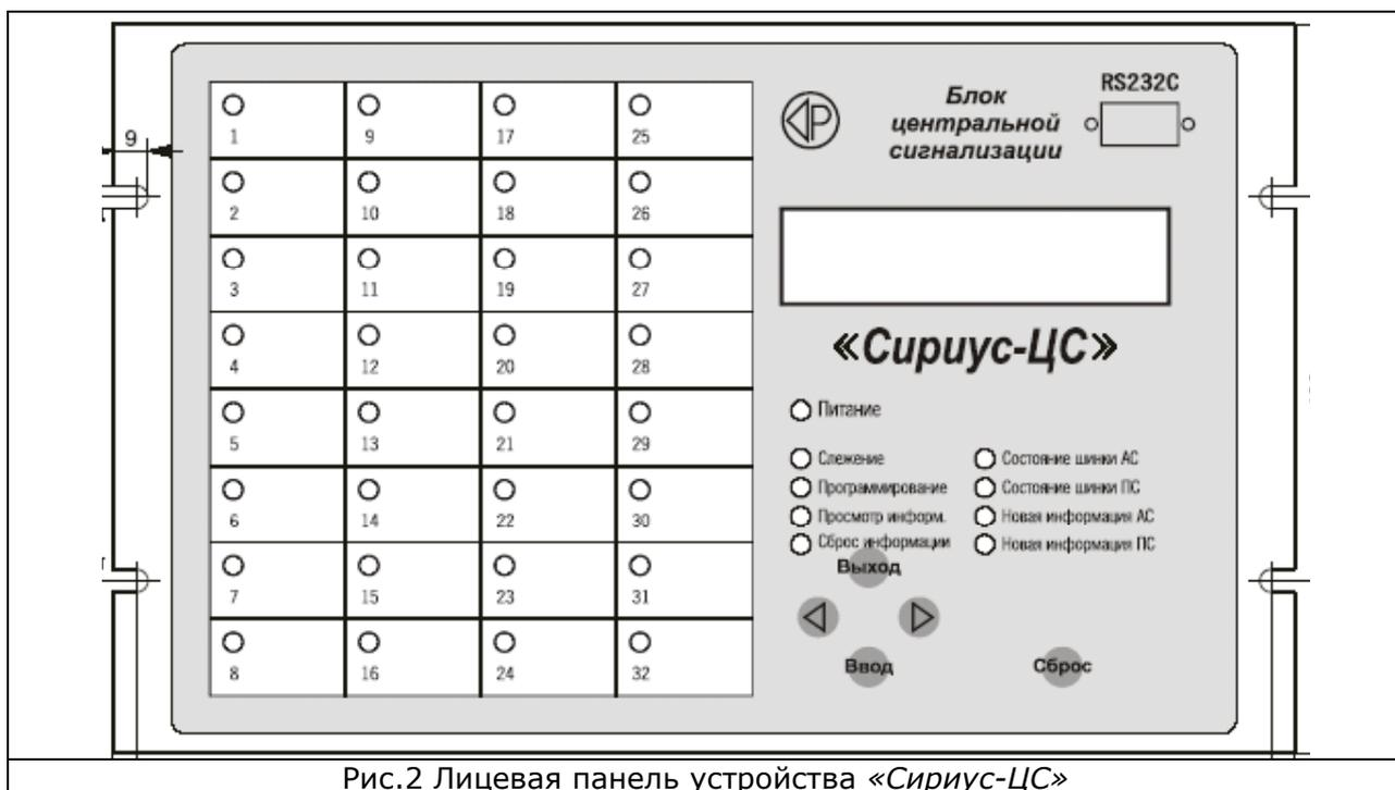
Рис.2 Лицевая панель устройства «Сириус-ЦС»
